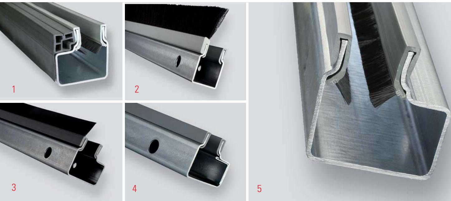
Unsere gängigsten Führungsschienen sind mit PVC Dichtleisten ausgestattet. Durch den Einsatz solcher Dichtleisten kann in der Regel eine erhebliche Verbesserung der Laufruhe beim Bewegen eines Rolltores und eine Reduktion des Verschleißes erreicht werden.
